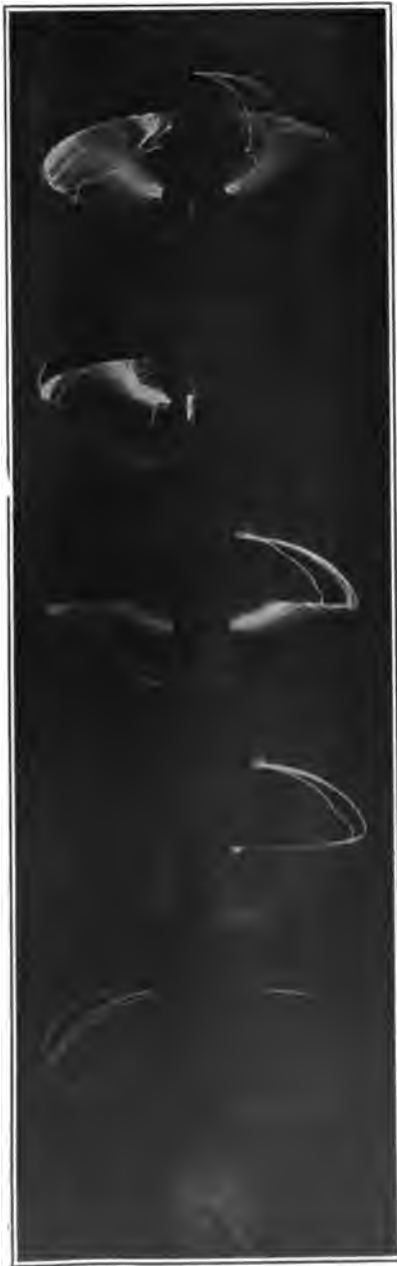
FIG. 8c—TYPE D—280 KV.— \frac{1}{2} IN. WATER PER MIN.—45 DEG.
