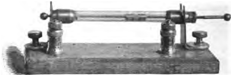
FIG. 10.—Coherer, about Actual Size.
