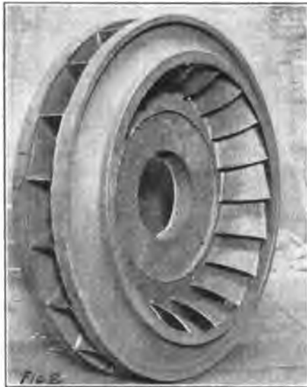
FIG. 2—55-IN. RUNNER 8000-h. p., 550-ft. head, 720-rev. per min.
