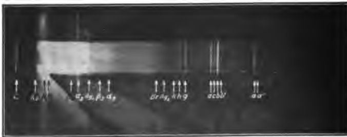
FIG. 8—X-RAY SPECTRUM OF TUNGSTEN
