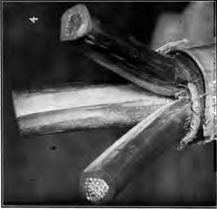
FIG. 4—18,000 VOLTS FOR 60 MINUTES] [TORCHIO]
